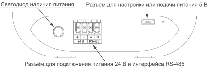
Рисунок 2 - Вид на боковую поверхность корпуса шлюза
